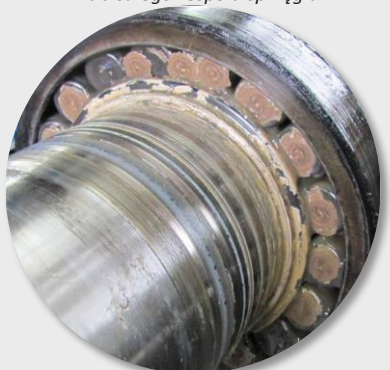
Wymiana łożysk oporowych
