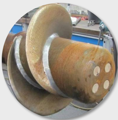
Naprawa wirnika mieszadła lub wymiana na nowy
